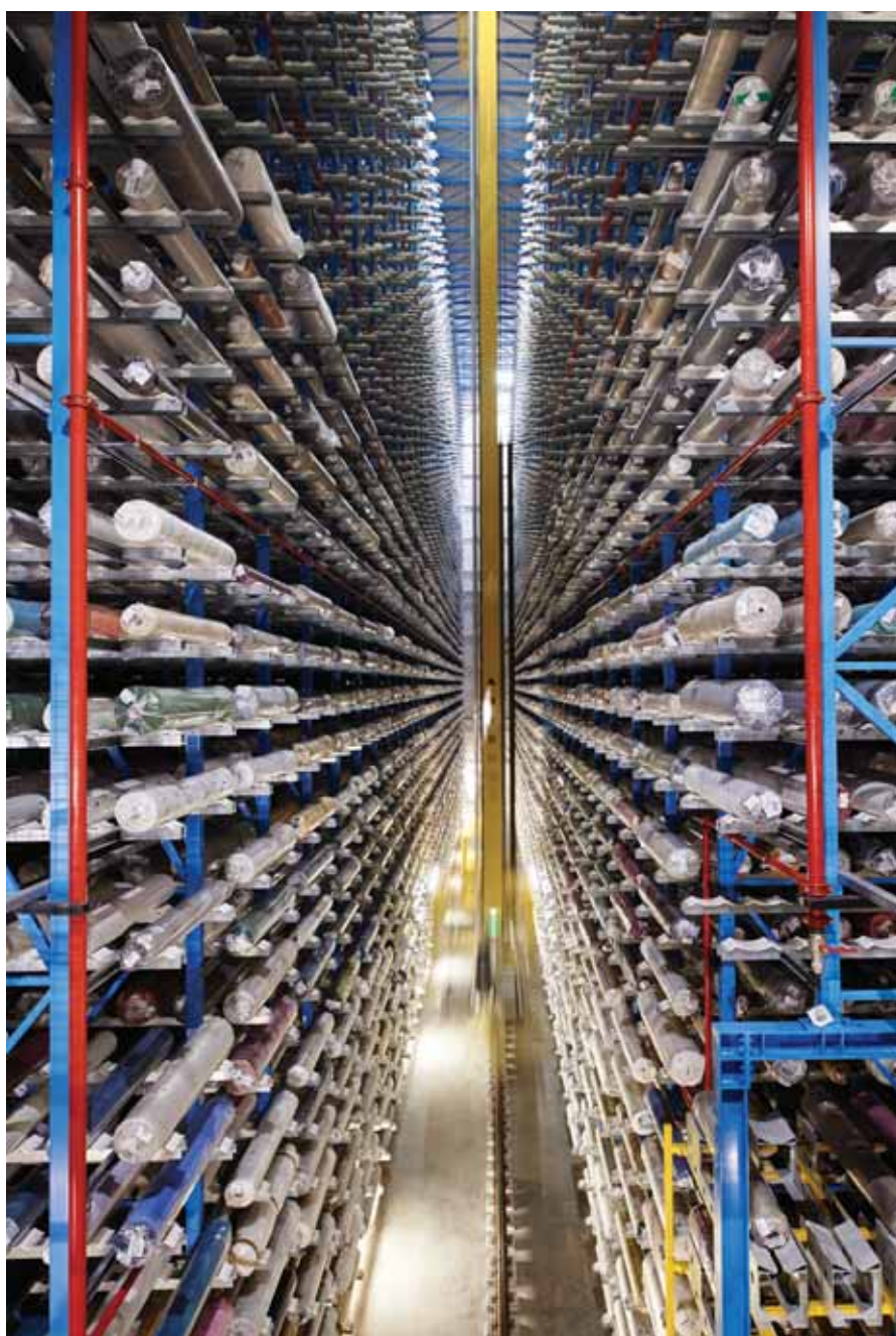
Langs minutieus geplaatste rekken schuiven torenhoge pylonen heen en weer, waarlangs volautomatische robots op en af glijden. Inchecking, storage, orderpicking en verzending verlopen volautomatisch.
